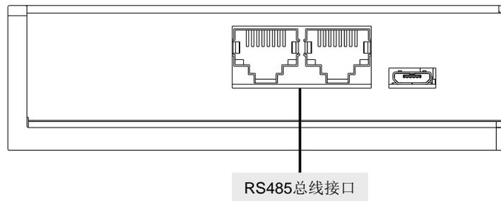
驱动器内置工业级总线通讯芯片，任何带 RS485 通讯功能的工业设备，都可以按照 Modbus-RTU 协议，直接控制驱动器的运行。如果有需要，可以串联最多 247 台驱动器，在较低的成本下，实现可靠的中到大型驱动器网络的构建。
