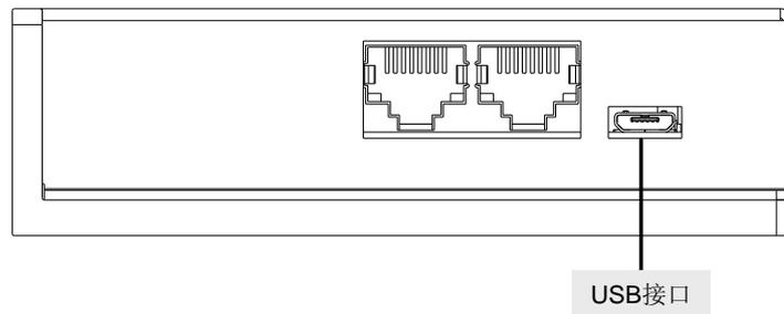
驱动器内置 USB 芯片，任何可以作为 USB 主机的设备，比如带 Windows 操作系统的电脑，可以按照 Modbus-RTU 协议，对驱动器进行参数设置，或者直接控制驱动器的运行。
