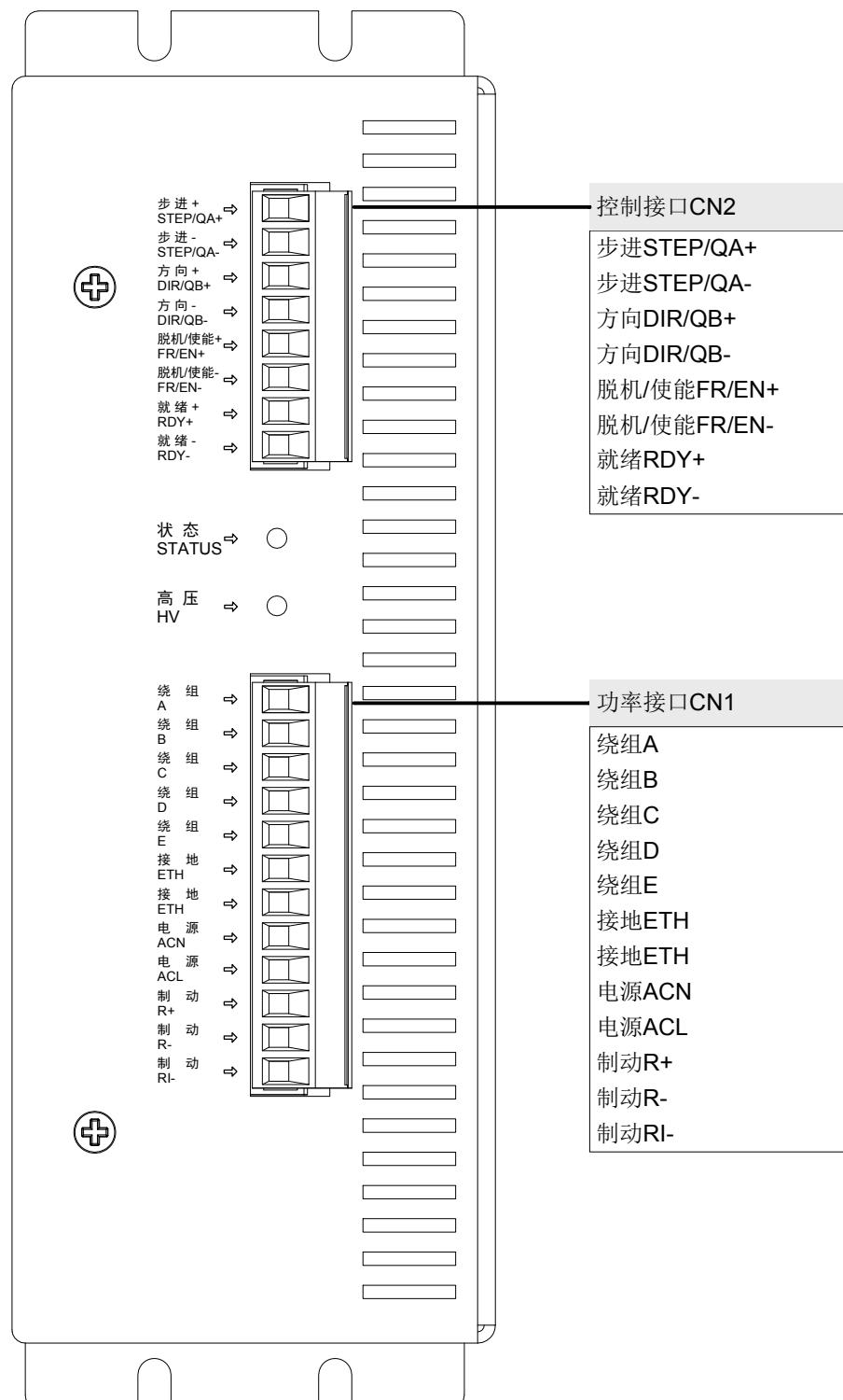
接线端子为可插拔式螺钉接线。
